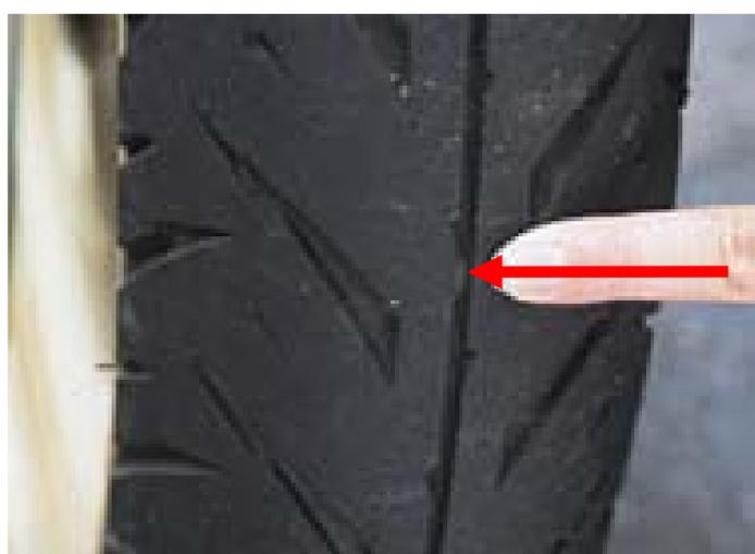
タイヤの側面にある△マークが目印      溝がなくなったらタイヤ交換を！
